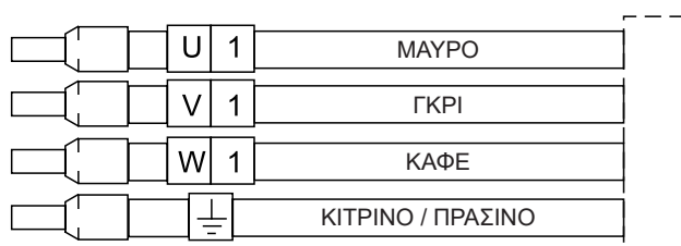
Αναγνώριση αγωγών καλωδίου ηλεκτρικών
